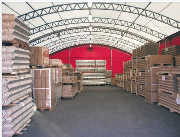
PMH Hyrhall har pelarfri golvyta och ljusgenomsläppligt tak.
